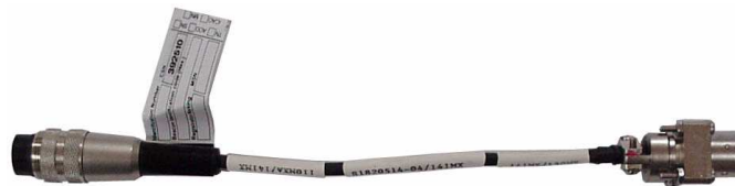
Figure 20: Programming dongle INTEGRA / SA
